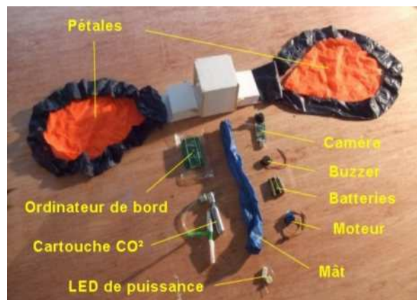
Fig. 3 : Les composants de HanaFlora ne sont restés que des "pièces détachées" et n'ont pas pu être intégrés pour réaliser un engin pleinement opérationnel.
