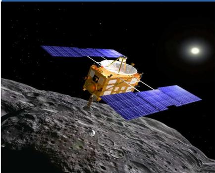
Hayabusa a la forme d'un parallélogramme rectangle de 1,50x1,50x1,05 m. qui pesait au lancement 530 kg, dont 50 kg de carburant pour les moteurs chimiques et 65 kg de xénon pour les moteurs ioniques, (vitesse d'éjection des ions à 32 km/s).
