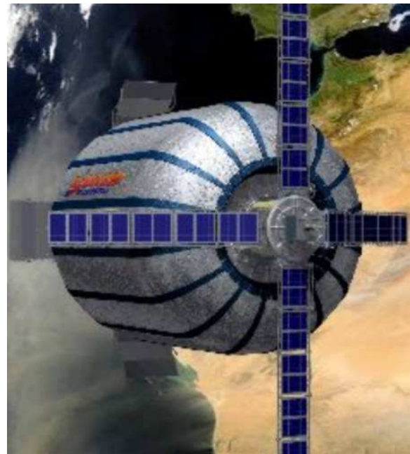
Fig. 4 – Le module gonflable expérimental Genesis-II, long de 4.4 m pour un diamètre de 2.4 m [ Bigelow Aerospace ]
